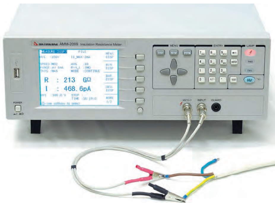
Рис. 18. Пример подключения прибора при измерении сопротивления изоляции жил кабеля
