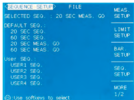
Рис. 10. Меню установки параметров последовательных измерений
