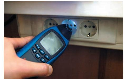
Рис. 7. Бесконтактный датчик напряжения и встроенный фонарик
