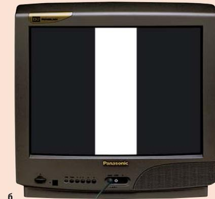
Рис. 6. Элемент измерительного сигнала B2 по ГОСТ 18471-83 (а — форма сигнала; б — вид на экране телевизора)
