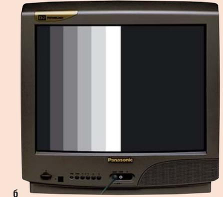
Рис. 8. Фрагмент измерительного сигнала I, содержащий элемент D1 (а — форма сигнала; б — вид на экране телевизора)
