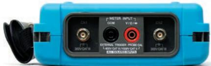
**Рис. 2. «ALL ISOLATED INPUTS» — ВСЕ ВХОДЫ ИЗОЛИРОВАНЫ — надпись на панели входных разъемов осциллографа ADS-4122**
