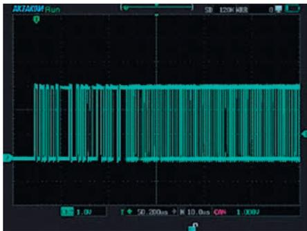
**Рис. 14. Режим запуска по сигналу последовательных шин**
