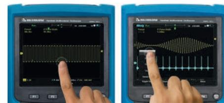
Рис. 13. Управление отображением сигнала на экране прибора жестами с использованием сенсорного экрана
