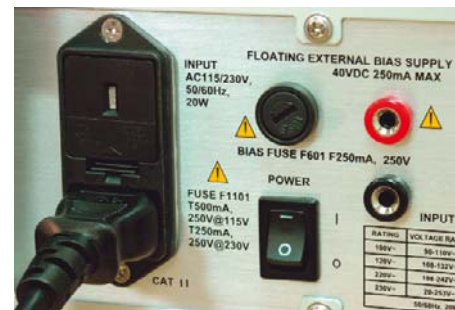
Рис. 12. Гнезда для подачи внешнего напряжения смещения
