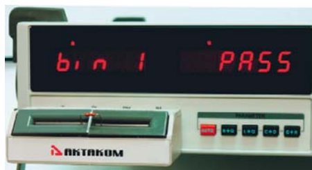
Рис. 15. Дисплей прибора при работе в режиме разбраковки
