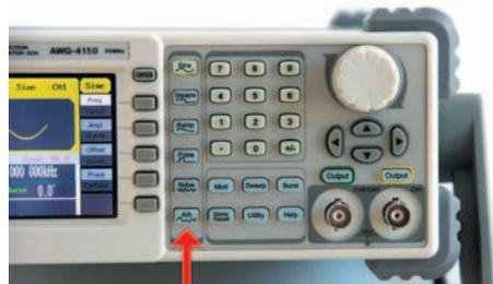
Рис. 7. Передняя панель генератора
