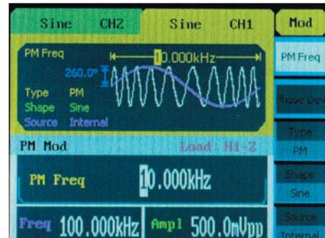
Рис. 25. Отображение сигнала с фазовой модуляцией
