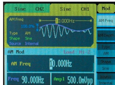
Рис. 23. Отображение амплитудно-модулированного сигнала
