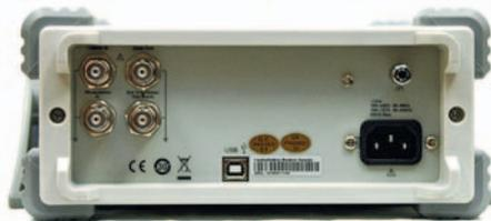
Рис. 28. Задняя панель генератора
