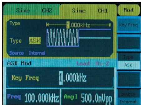
Рис. 27. Отображение сигнала с амплитудной манипуляцией
