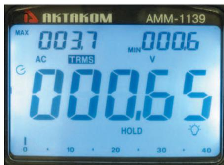
Рис. 5. Дисплей АММ-1139 с отображением максимальных и минимальных значений измеряемой величины
