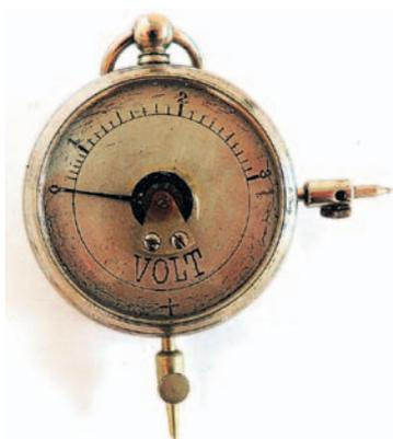
До появления первых мультиметров появились приборы, измеряющие только одну физическую величину. В частности, в начале прошлого века в Германии успешно производились переносные вольтметры в виде популярных в то время, часов-луковиц, так как размер прибора был идентичен размеру таких карманных часов. Приборы можно было брать с собой в удобном кожаном чехле, включающем в себя инструкцию по использованию или просто положить в карман, прикрепив к ним цепочку, как обычный хронометр.
