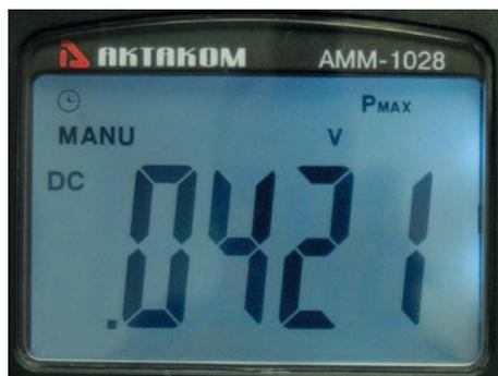
Рис. 13. Фиксация пиковых значений в мультиметре АКТАКОМ АММ-1028
