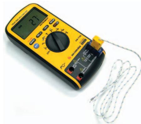
Рис. 16. Мультиметр АКТАКОМ АМ-1152 с подключенной термопарой
