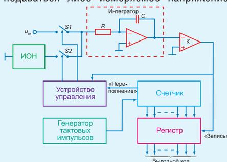
Рис. 1. Структура АЦП двойного интегрирования
