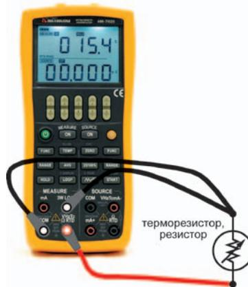
Рис. 27. Подключение в режиме измерения температуры с помощью терморезистора
