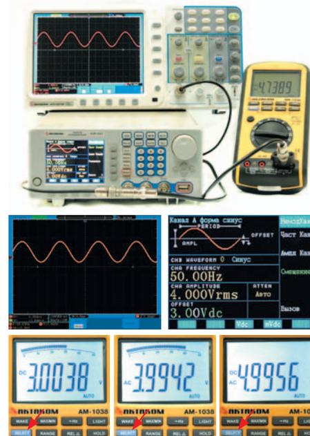
Рис. 9. Мультиметр АМ-1038. Индикация постоянного напряжения (внизу слева), переменной составляющей (внизу в центре) и постоянной + переменной составляющих (внизу справа)
