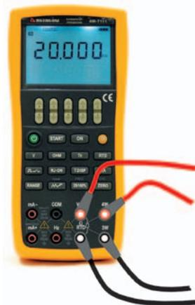
Рис. 23. Коммутация калибратора AM-7111 в режиме имитации сопротивления и эмулирования сопротивления терморезисторов
