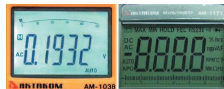
Рис. 3. Дисплеи современных цифровых мультиметров с графической шкалой
