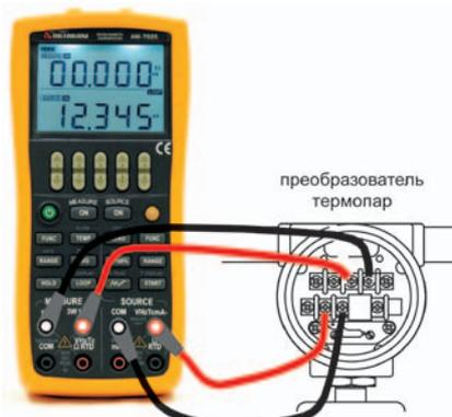
Рис. 26. Схема соединений для калибровки преобразователей
