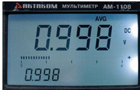
Рис. 11. Отображение средней величины в прецизионном мультиметре АКТАКОМ АМ-1108
