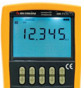
Рис. 18. Кнопки управления разрядами калибратора
