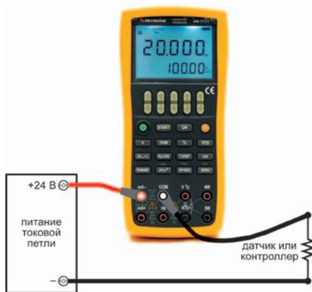
Рис. 22. Коммутация AM-7111 для имитации передатчика
