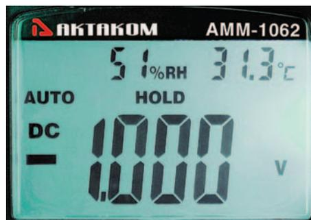
Рис. 6. Дисплей АММ-1062 с отображением условий окружающей среды при проведении измерении электрической величины
