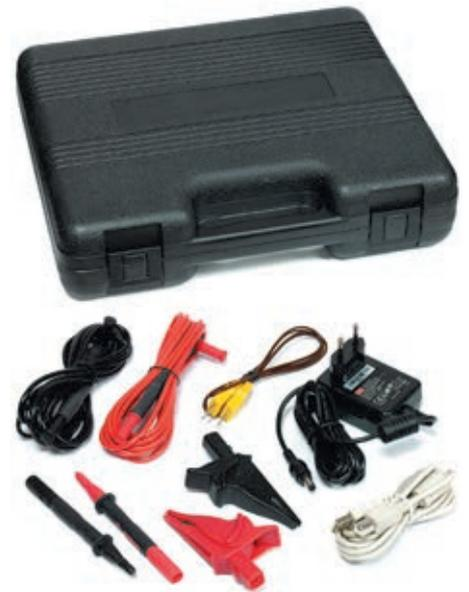
Рис. 10. Стандартная комплектация калибратора AM-7113
