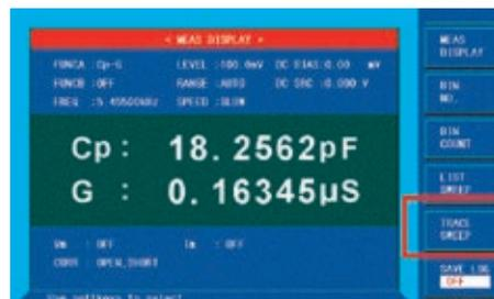
Рис. 10. Кнопка включения режима TRACE SWEEP на экране меню измерений прибора АММ-3088
