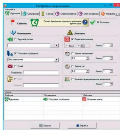
Рис. 9. Окно настроек синхронизации программы Aktakom Power Manager версии 1.0.5.1
