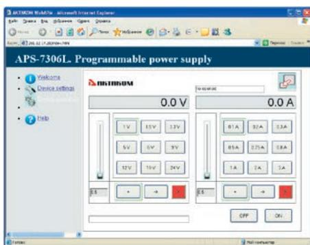
Рис. 7. Web-интерфейс источника питания APS-7306L
