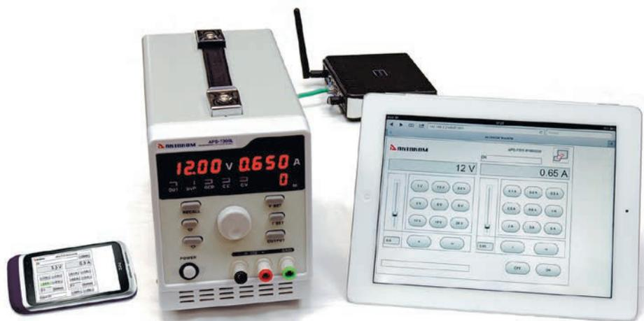
Рис. 2. Управление источниками питания АКТАКОМ APS-73xxL через Web-интерфейс
