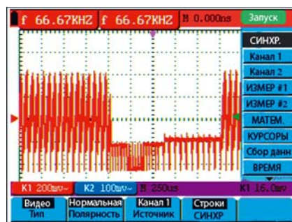
Рис. 4. Запуск по кадровому синхроримпульсу
