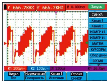
Рис. 5. Запуск по строчному синхроримпульсу
