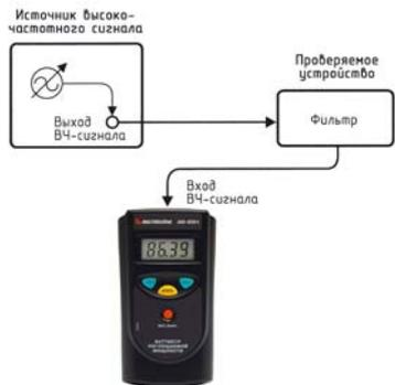
Рис. 3. Измерение непрерывного излучения
