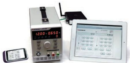
Рис. 1. Лабораторный источник питания АКТАКОМ APS-7305L
